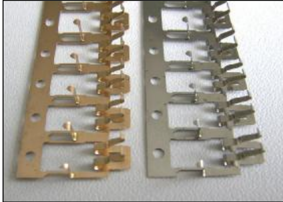
Figure 8. 自動車アプリケーションでの接点バネ要素 (左: CuBe2, 右: DURACON 17A).
